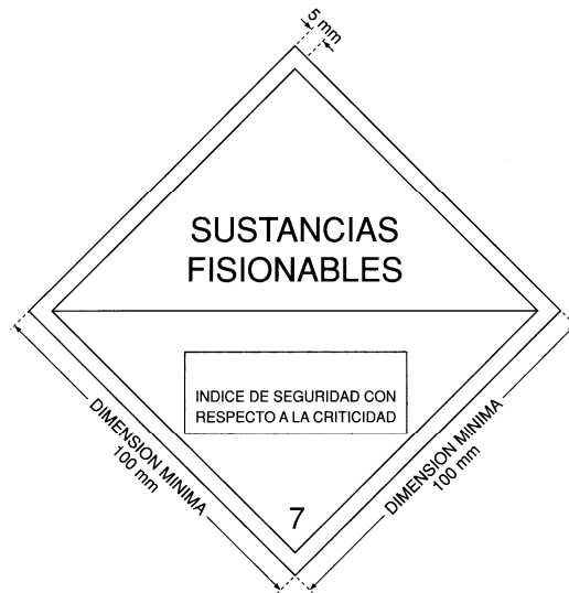
FIGURA 5. Etiqueta para el índice de seguridad con respecto a la criticidad. El color de fondo de la etiqueta será blanco y los caracteres y líneas impresos serán negros.
