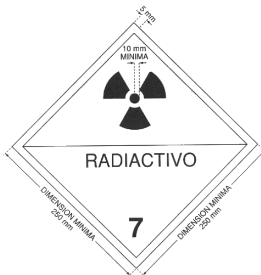
FIGURA 6. Rotulado. Salvo en los casos permitidos en el Artículo 149, las dimensiones de este modelo son las mínimas; cuando se utilicen rótulos de distintas dimensiones se guardarán las mismas proporciones que en el modelo. El número "7" tendrá una altura no inferior a 25 mm. El color de la mitad superior del rótulo será amarillo y el de la mitad inferior blanco, el trébol y los caracteres y líneas impresos serán negros. El empleo del término "RADIATIVO" en la mitad inferior es facultativo, con el fin de permitir también la utilización de este rótulo para indicar el número apropiado de la Naciones Unidas correspondiente a la remesa.
